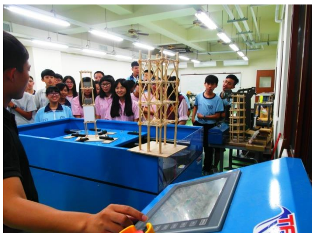
何厚緯老師示範完成的模型抗震穩定度
